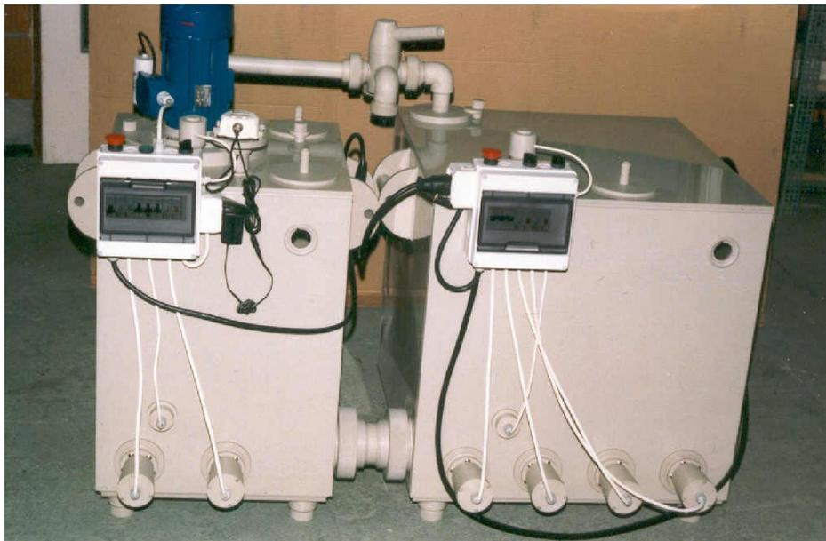
полную химическую стойкость к таким веществам как: минеральные кислоты, азотная кислота, фосфорная кислота, соляная кислота; органичные, такие как: муравьиная кислота, уксусная кислота, лимонная кислота и натровый щелок. Аппараты UC 10/20-1-M и UC-10/40-1-M могут применяться в качестве смесителя, аппарата для перекачки и реактора.
